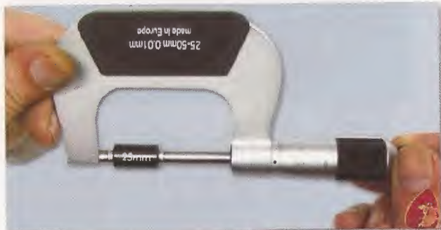
Verificación de ajuste del micrómetro
